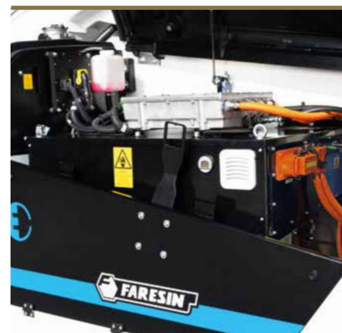
K dispozici jsou 435V lithiové baterie s výkonem 105 Ah.
