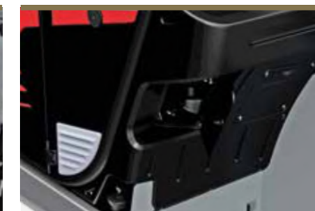
U modelů s motory SCR je vzadu umístěna nádrž na AdBlue.
