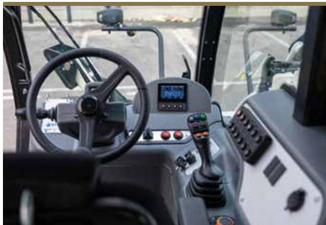
Kabina a proporcionální elektro-hydraulická ovládací páka ve standardní výbavě modelu Big Range Full Electric.
