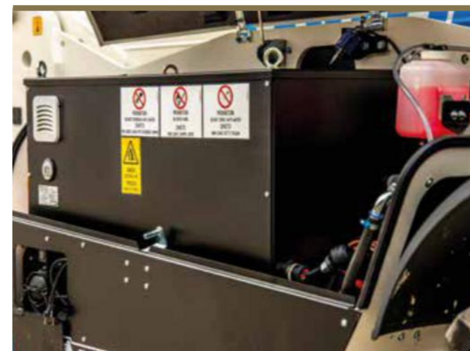
K dispozici jsou 80V lithiové baterie s výkonem 315, 420 nebo 560 Ah.
