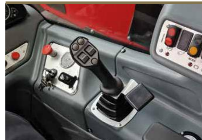
Multifunkční ovládací páka s proporcionálním elektro-hydraulickým ovládním je ve standardním vybavení ve verzích HLS a VPSe.
