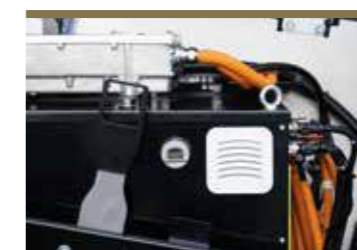
Prostor pro baterii s monitorovacím systémem.
