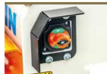
Ruční vypínač baterie umístěný na přední straně stroje.
