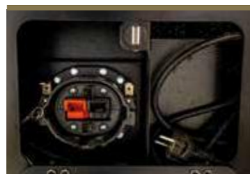
Zásuvka pro nabíjecí stanice, integrovaná na 6.26 Full Electric.
