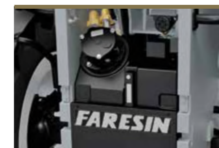
Zásobník hydraulického oleje s hladinoměrem.
