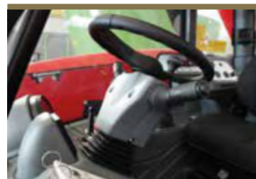
Stavitelný sloupek řízení, pomocí postranní páčky.
