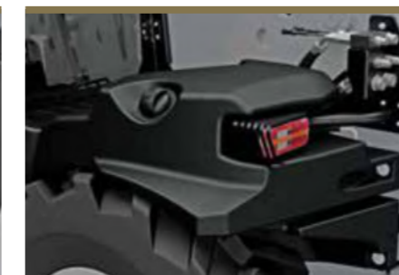
U modelů řady FS Compact ve verzi Low Cab je naftová nádrž umístěna za kabinou.
