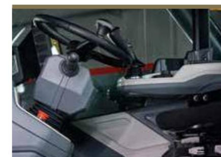
Sloupek řízení sklopný pomocí boční páky.
