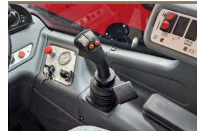
Standardní proporcionálně elektro-mechanická ovládací páka u verzí CLASSIC.
