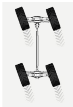
Krab: pojezd stranou do těžko přístupných míst.
