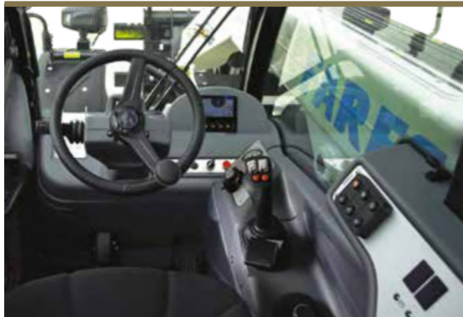
Kabina a proporcionální elektro-mechanická ovládací páka ve standardní výbavě modelu 6.26 Small Range Full Electric.
